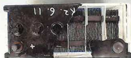
静電気が原因で破裂が発生した写真
